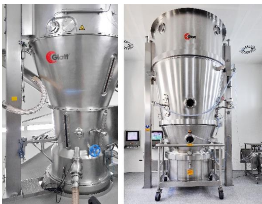
Abb. 1: Links: Wirbelschichtgranulator mit kontinuierlichem Produktaustrag, rechts: Batch-Wirbelschicht-Granulator und -Coater. Beide Anlagen im Glatt Technologiezentrum in Weimar verarbeiten lösemittelbasierte Produkte.
